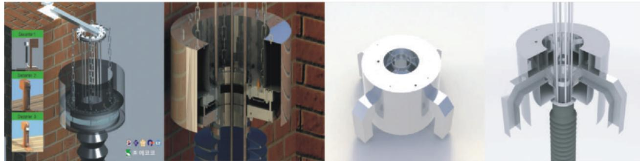
本产品是根据反应槽的表面水位差异，Diaphragm Decanter的位置以上下自动移动，使用压缩空气，快速排出上澄水。根据排出量，自动调节水位。根据压缩空气量，可调节速度。
