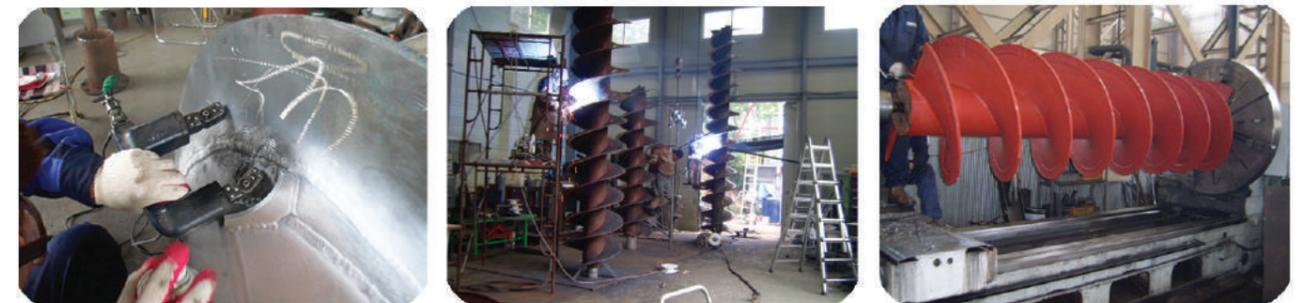
石灰石卸装机 Vertical Screw (垂直螺旋)
